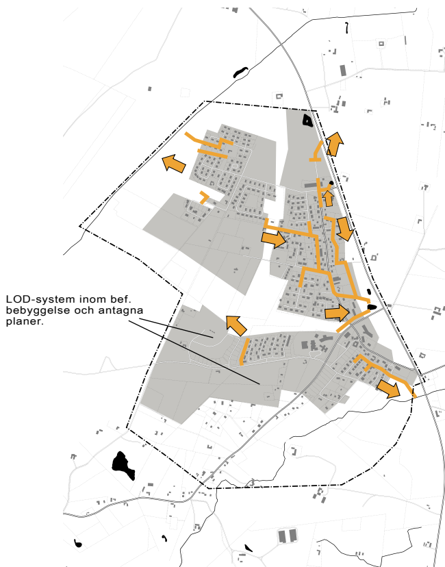
Figur 5.33: Dagvatten: Utbyggnadsområde med befintliga ledningar och avrinningsriktning.
