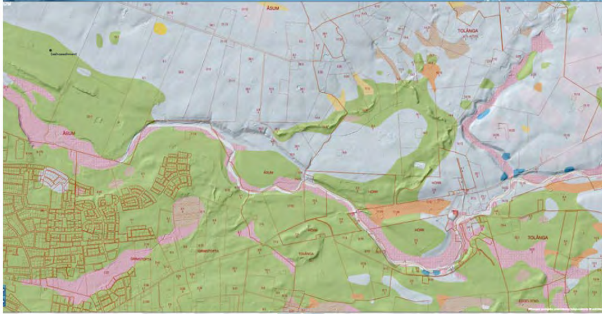
Figur 93. Sjöbo, Omma-Åsum, östra delen. Grönt visar isälvsediment. Ljusblå sandig morän, ljus rosa lermorän. Orange visar sand. Ljusbrun med blå prickar visar kärrtorv. Rosa svämsediment. Vitt med blå skraffering visar fyllning. Jordartsdata från SGU.
