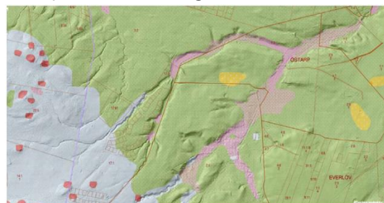
Stora Rödde – Östarp. Utmed Orehusabäckens biflöde (norr) och Avelsbäcken finns svämsediment, rosa. Grönt visar isälvs material och sand. Ljusblå morän. Gult visar silt och ljusbrun med blå prickar visar kärrtorv. Rött urberg.
