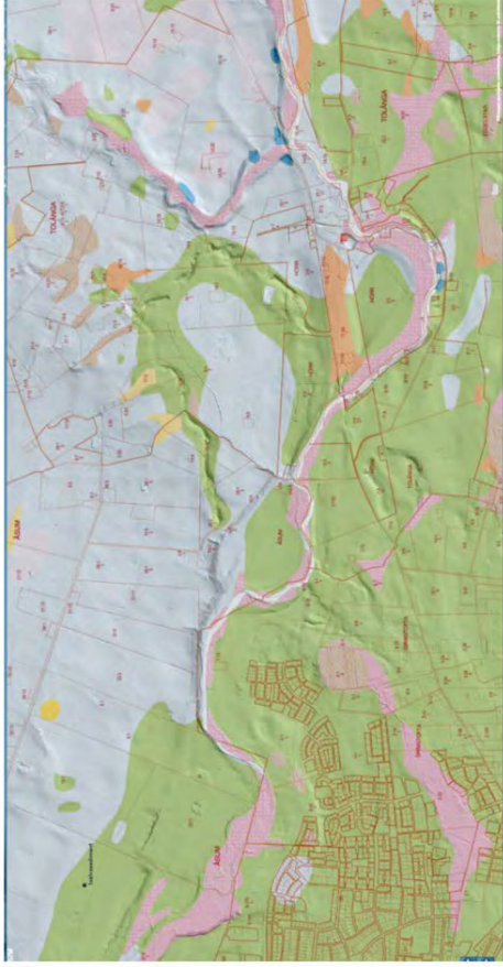
Figur 93. Sjöbo, Omma-Åsum, östra delen. Grönt visar isålvssediment. Ljusblå sandig morän, just rosa lermorän. Orange visar sand. Ljusbrun med blå prickar visar kärrtorv. Rosa svämsediment. Vitt med blå skraffering visar fyllning. Jordartsdata från SGU.
