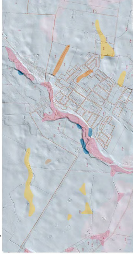
Figur 97. Vollsjö. Ljusblå lerig morän. Orange visar lera. Gult visar sand och ljusbrun med blå prickar visar kärtröner. Ljusrosa svämsediment samt mörkblå sedimentärt berg. Jordarsdata från SGU.
