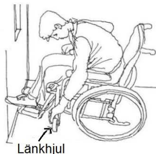
Figur 1 Länkhjulen fram är små för att underlätta manövreringen men innebär också att hjulen kan ställa sig på tvären vid kanter som inte är avfasade.
