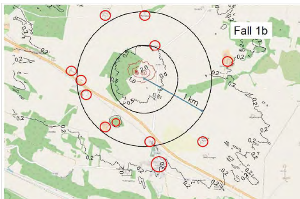
Figur 28. Spridningsbild för luft enligt fall 1b. Röda isolinjer markerar luftstyrkor från 1 \text{ OUE}/\text{m}^3 och högre. Bostäder inom cirka 1 kilometer från planerad verksamhet är markerade med röda cirklar i bilden.
