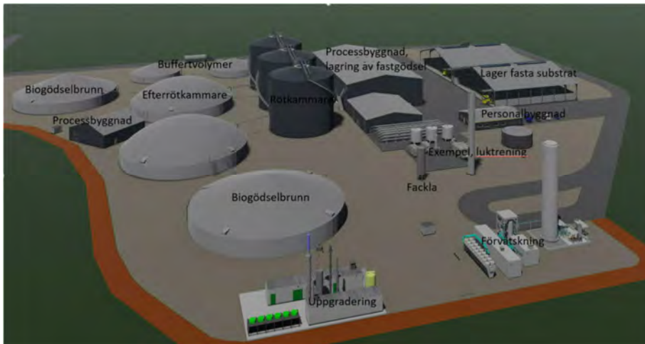
Figur3. Exempel på layout av biogasanläggning (Gasum)
