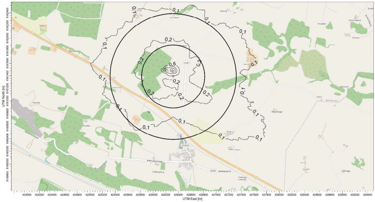
Figur 4 Spridningsbild för lukt, 99-percentilen vid modellerade normalförhållanden enligt fall 1b (utsläppsnivå +25 meter).
