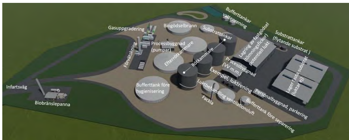
Figur 4: Exempel på anläggningens utformning.
