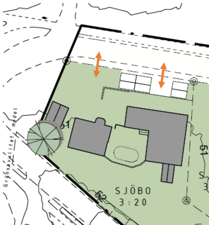
Utdrag ur illustrationsplanen som visar hur parkering kan anordnas inom fastigheten Sjöbo 3:20 med två utfarter (pilar) för att undvika backrörelser ut mot Tolångavägen.
