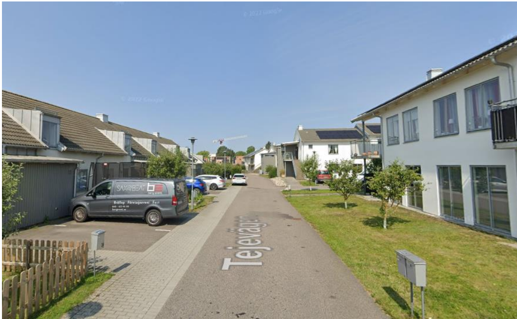
Figur 8. Exempel på gångbana och körbana i samma nivå från Tejevågen i Lund (Google Maps, 2024).
