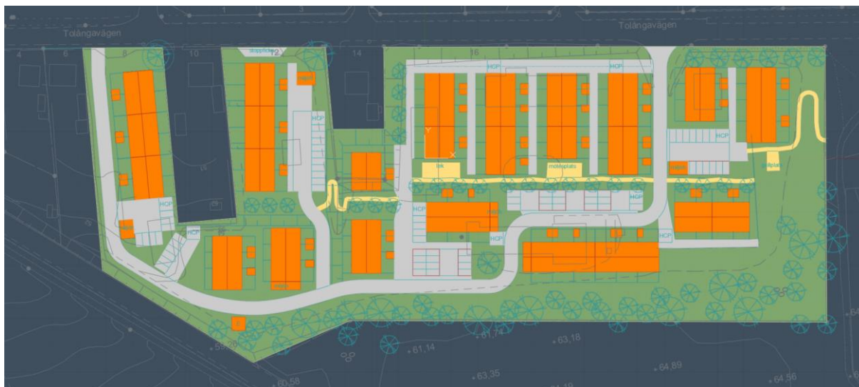
Figur 10 Områdesindelning för beräkningar för den nya exploaterade situationen. Området delas in i fyra övergripande kategorier av ytor med olika avrinningskoefficienter: takyta (orange), asfalt (grått), grus (gult) och grönytor (grönt).
