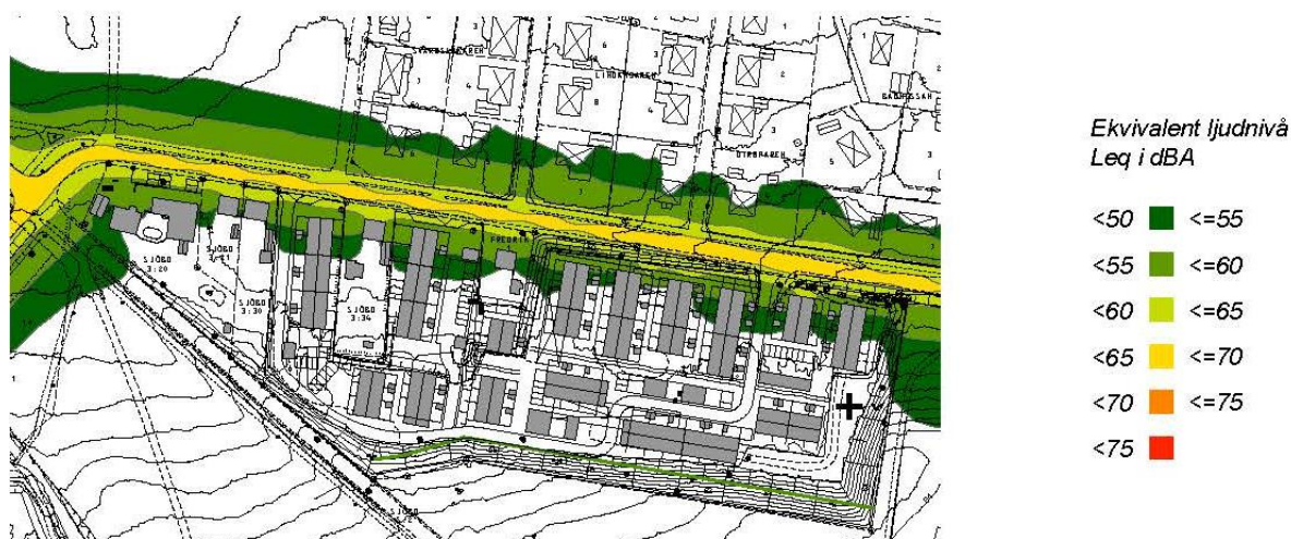
Kartutsnitt över utbredning av trafikbuller i planområdet 2040 (ekvivalent ljudnivå) från rapporten Sjöbo Bullerkartläggning utförd av AFRY 2022.
