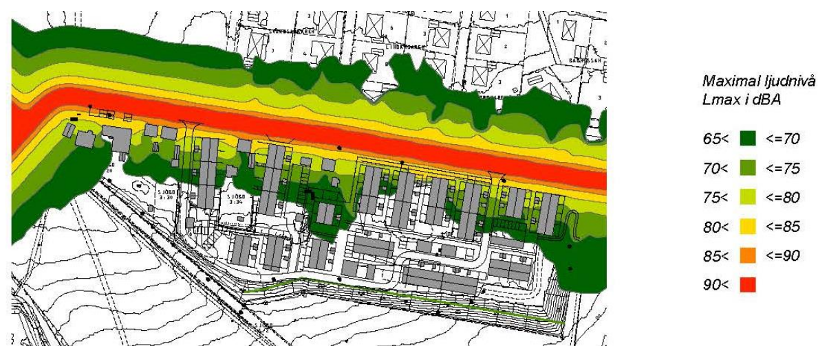
Kartutsnitt över utbredning av trafikbuller i planområdet 2040 (maximal ljudnivå) från rapporten Sjöbo Bullerkartläggning utförd av AFRY 2022.
