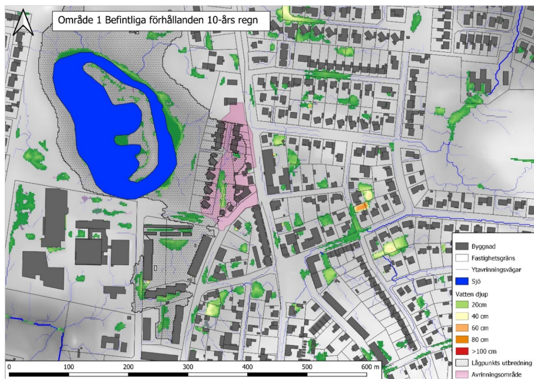
Figur 11 Avrinningsområde och vattendjup i lågpunkter för område 1 vid 10-års regn i dagsläget.
